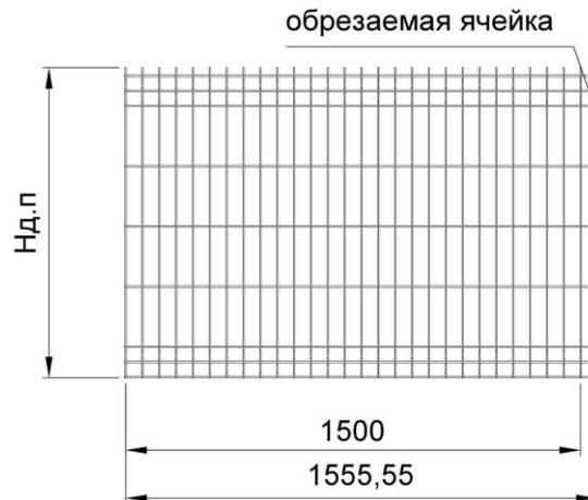
**Рис. 4. Обрезка доборной панели.**
